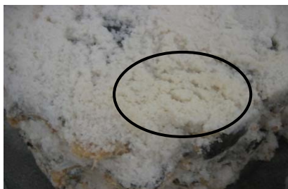
Bilde 12: Område med misfarget salt øverst på pall salt brukt til salting i 4 døgn.
