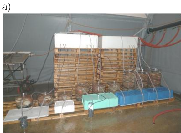
Figur 3.2- Beregning av oksygenforbruk ved modifiserte respirometere og gjennomsnittsvanna a) September 2010, målt for liten, middels og stor sylinder. b) 3 replikater for liten sylinder april 2011.
