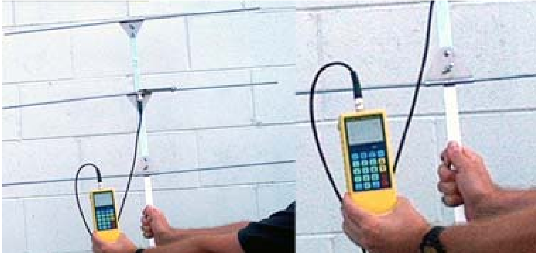
Bilde 6 Radiopeliler og antenne som bestemmer retning til radiosender ved vridning på antenne. Dette er samme enheten som kan brukes for å lese av VHF/GPS senderne som er omtalt under.
