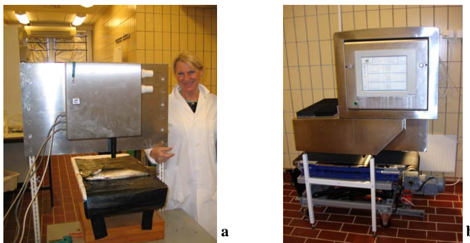
Figur 3: To typer NIR instrumenter: Punktmåler (a) måler NIR spekter i et punkt i fisken. Spekteret kan måles med og uten kontakt mellom fisken og NIR proben. Scanneren (b) scanner hele fisken, uten kontakt mellom instrumentet eller fisken.
