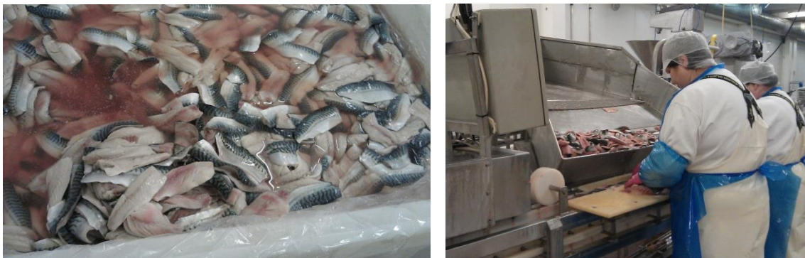
Figur 1 a, b. Tining av råstoff hos Sandanger AS. Tining i kar til venstre, porsjonering på båndet til høyre.
